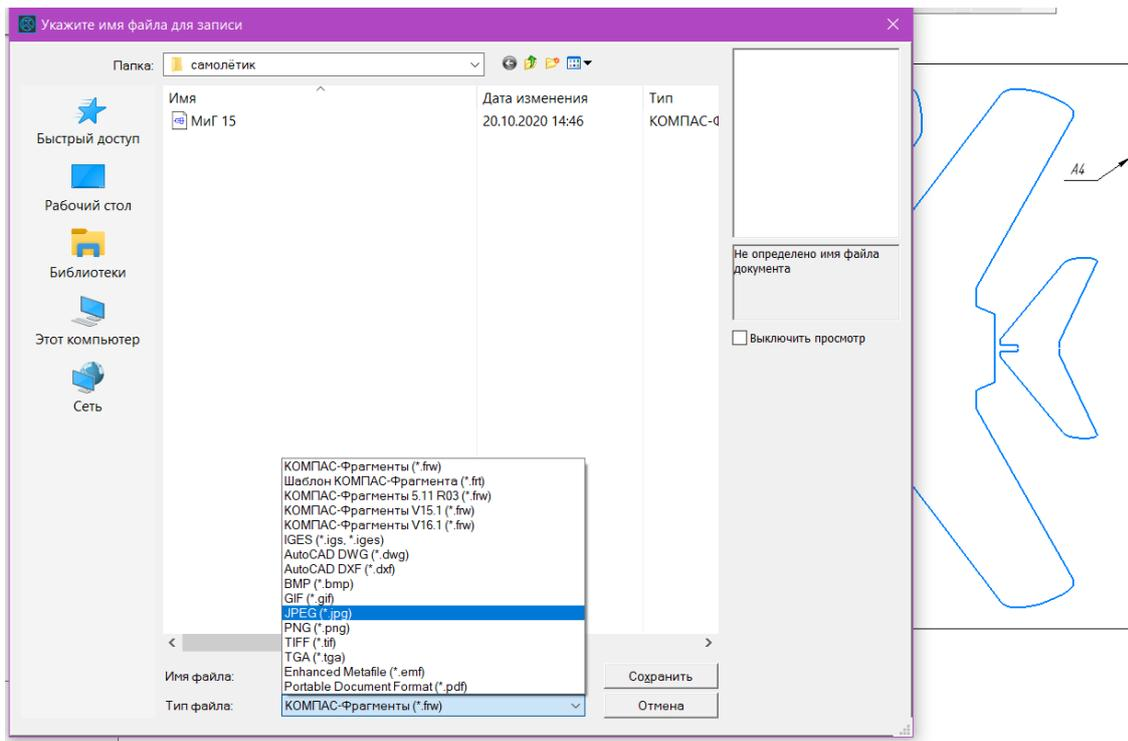
И сохраняем как AutoCAD (.dxf) для резки на лазерном станке.
